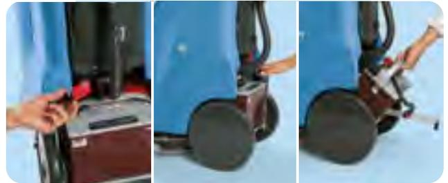
La simplicité de remplacement de la batterie épuisée par la nouvelle permet d'augmenter l'autonomie de la machine également pendant plusieurs cycles de travail.
