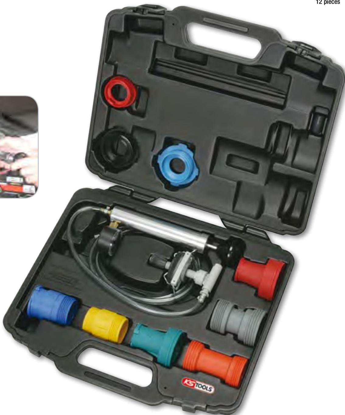
Le testeur universel permet de vérifier l'étanchéité du système de refroidissement et des bouchons de radiateurs. Le système d'étanchéité par membrane gonflable permet d'utiliser le testeur pour la plupart des véhicules légers. Les radiateurs ou vases d'expansion s'adaptent sur les embouchures à baïonnette ou filetées. 9 adaptateurs conviennent pour le test de la plupart des bouchons de radiateurs.
