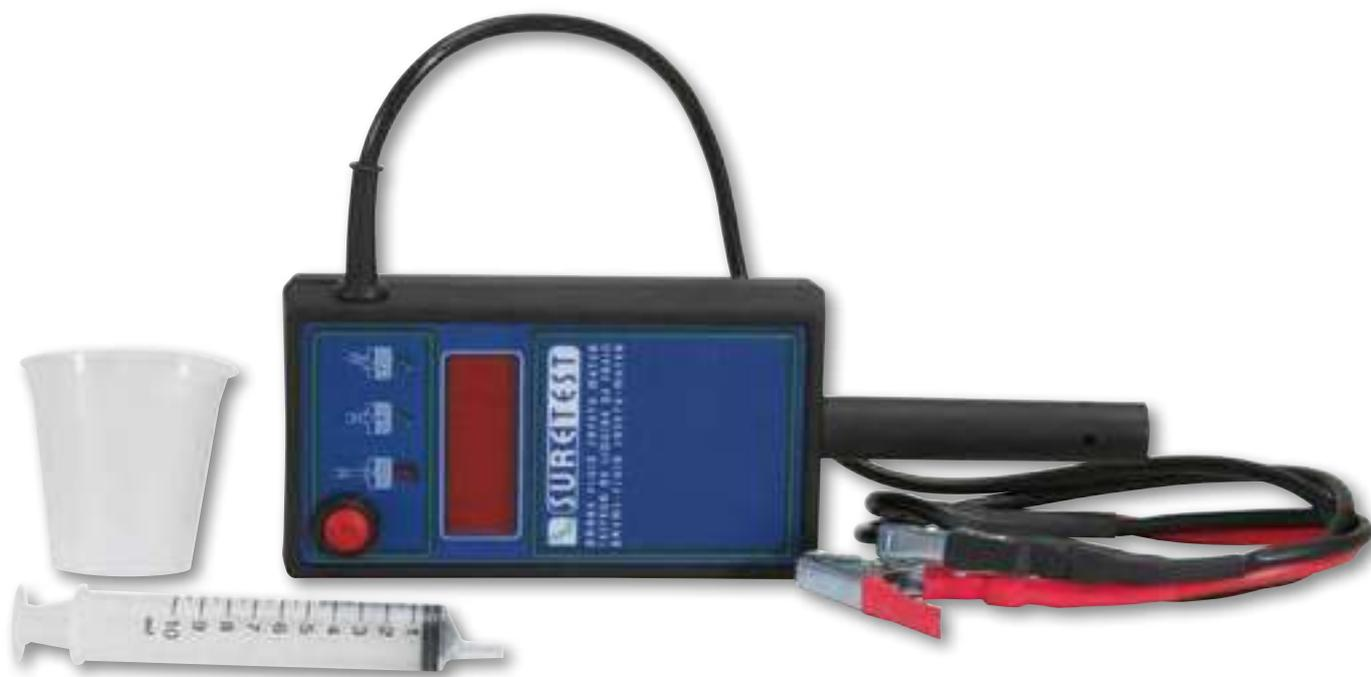
Le liquide de frein est très sensible à l'humidité. C'est pourquoi notre testeur va mesurer le taux d'hygrométrie dans le liquide de frein. Il suffit de tremper le testeur dans le réservoir de liquide de frein (DOT 3, 4 ou 5.1) puis de brancher les câbles sur les bornes de la batterie pour alimenter l'écran. La seringue permet de réaliser le test lorsque l'accès au réservoir est difficile. Le testeur indique s'il faut remplacer ou non le liquide du circuit de freinage.
