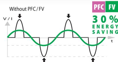
De dernière génération, le PROGYS 200E dispose d'un PFC de grande envergure qui le rend FLEXIBLE VOLTAGE (85-265V).
