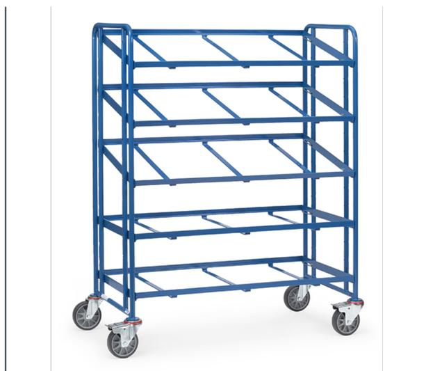
Ensemble mécano-soudé, revêtement époxy bleu RAL 5007. 5 plateaux amovibles en profilé avec armature ouverte pour 3 bacs plastiques 600 x 400 mm. Plateaux réglables au pas de 100 mm et inclinables de 15° et 30°. 4 roues pivotantes à bandage TPE, moyeu à roulement à billes. 2 roues avec freins conformément à la Norme 1757-3 (Sécurité des chariots de manutention). Charge par plateau : 80 kg. Livré sans bacs.
