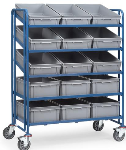
Ensemble mécano-soudé, revêtement époxy bleu RAL 5007. 5 niveaux amovibles armature ouverte avec 3 bacs euro 600 x 400 x 145 mm, 6 bacs euro 600 x 400 x 170, 6 bacs euro 600 x 400 x 220 mm. Plateaux réglables au pas de 100 mm et inclinables de 15° et 30°. Charge par plateau 80 kg. 4 roues pivotantes à bandage TPE, moyeu à roulement à billes. 2 roues avec freins conformément à la Norme 1757-3 (Sécurité des chariots de manutention).
