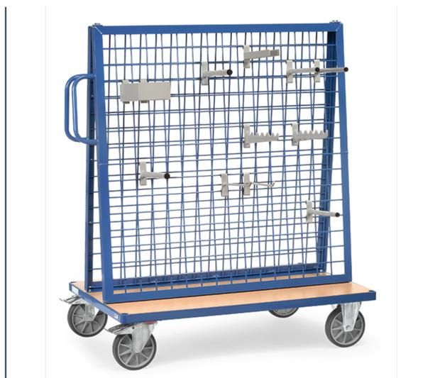
Ensemble mécano-soudé, revêtement époxy bleu RAL 5007. Plateau en mélaminé surface effet hêtre avec un panneau en treillis métallique 75 x 75 mm. 2 roues fixes et 2 roues pivotantes à bandage TPE, moyeu à roulement à billes. Freins sur roues pivotantes. Hauteur utile : 1250 mm. Hauteur totale : 1500 mm. Inclinaison : 11 %.
