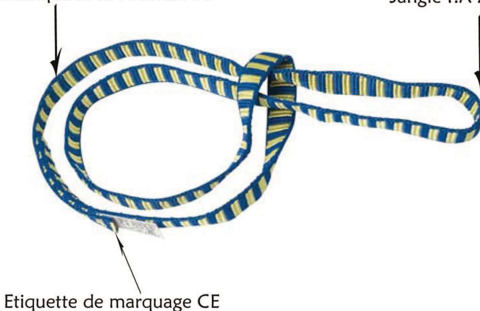
**Produit et utilisation :** Point d'ancrage mobile. Polyamide, à utiliser avec un système antichute conforme EN 353-2, EN 355, EN 360. Le point d'ancrage doit être positionné au-dessus de l'utilisateur
