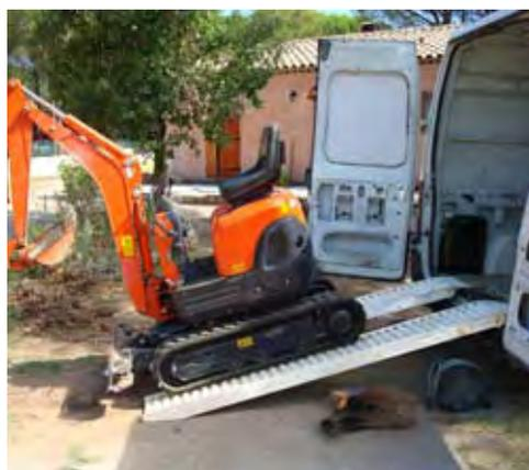
Les rampes AVS 80 permettent le passage de pneumatiques ou de chenilles caoutchouc.
