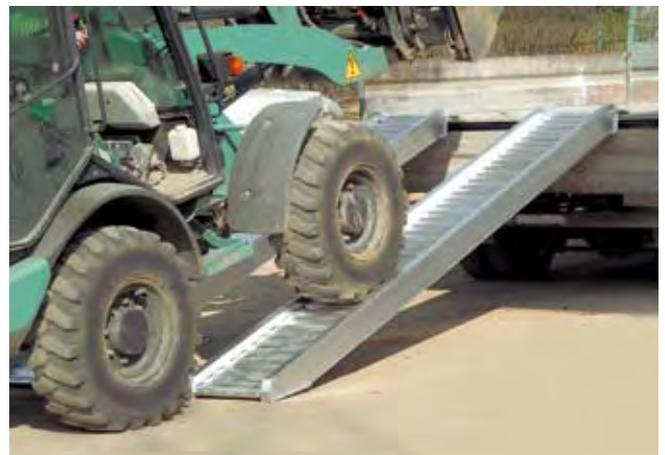
Les rampes AVS 200 permettent le passage de pneumatiques ou de chenilles caoutchouc. En standard chaque rampe est livrée avec une lèvre d'appui munie d'un goujon amovible (longueur 80 mm) et d'un anneau permettant le passage d'une chaîne ou d'une sangle (non fournie). Pour les rebords latéraux 3 possibilités à choisir suivant les repères. Existe en modèle repliable avec équilibrage. N.B. : pour le passage de rouleaux prévoir un tapis caoutchouc.
