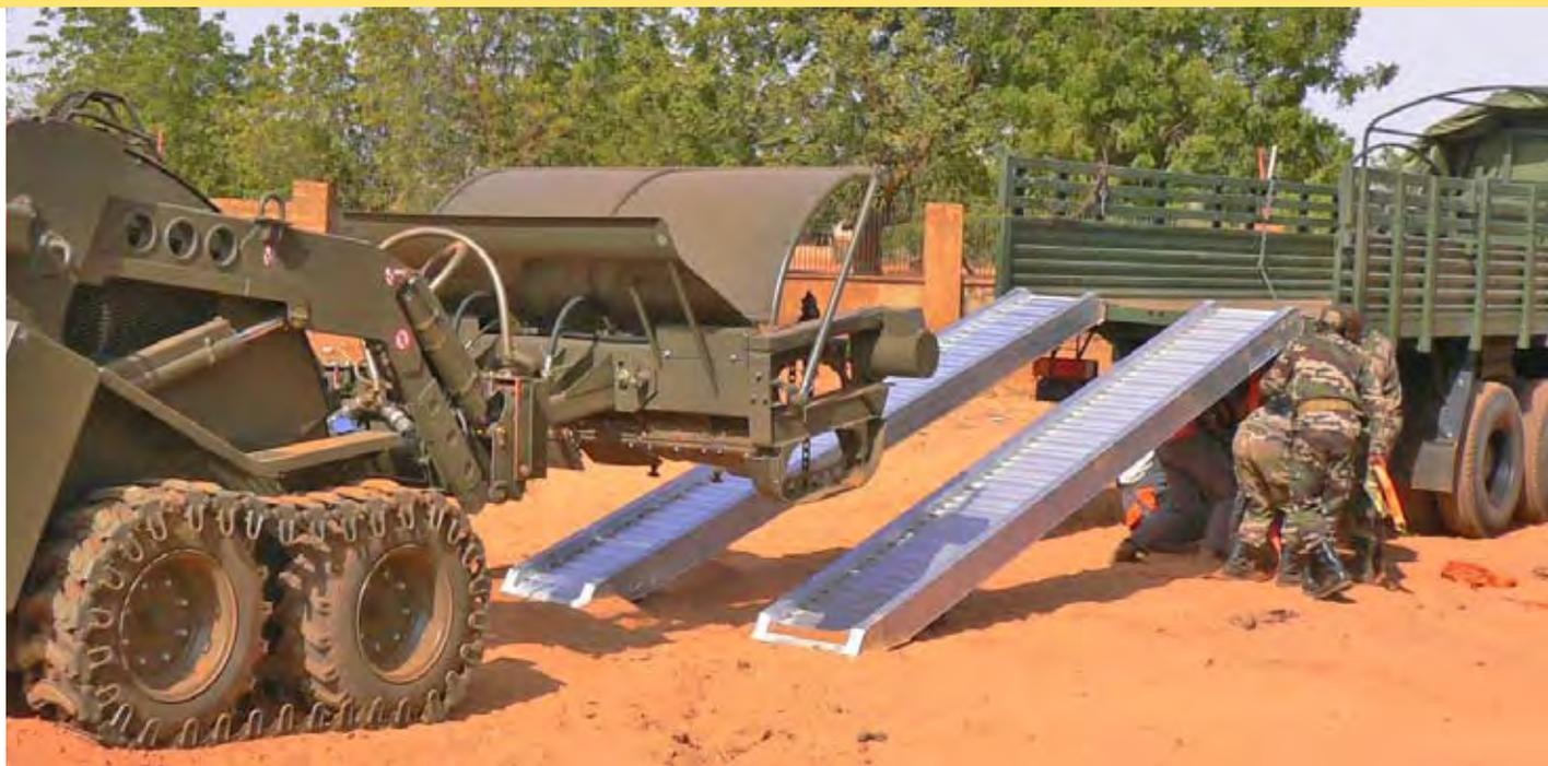
Ce modèle de rampes est conçu pour le passage de chenilles en acier ou de roues munies de bandages en caoutchouc.
