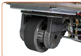
Moto roue directionnelle et de propulsion surdimensionnée pour un déplacement optimal.
