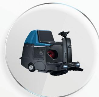
Balayeuse tractée avant-arrière hybride qui utilise une alimentation combinée de moteur à essence et de batteries. Elle est idéale pour les espaces aussi bien intérieurs qu'extérieurs : en choisissant l'alimentation à essence pour l'extérieur ou le faible niveau sonore du moteur électrique pour l'intérieur. Bannage manuel.
