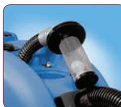
Le réservoir de récupération est doté d'un filtre AIR STOP qui protège le moteur d'aspiration des remontées de solution et/ou résidus solides.
