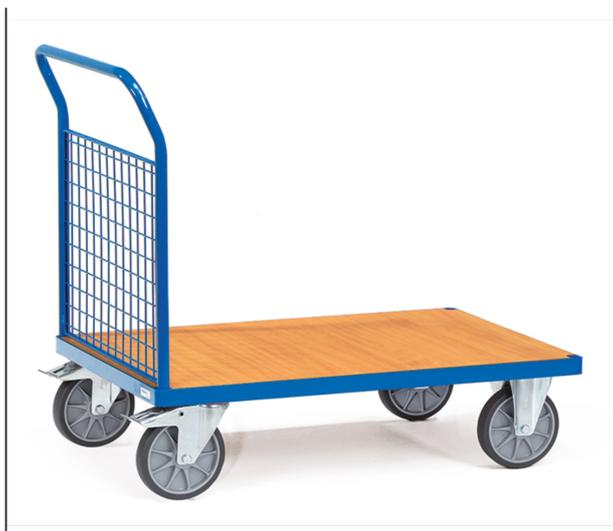
Ensemble mécano-soudé, revêtement époxy bleu RAL 5007, plateau en mélaminé surface effet hêtre avec une ridelle en treillis métallique 50 x 50 x 4 mm, hauteur 500 mm. 2 roues pivotantes et 2 roues fixes à bandage TPE, moyeu à roulement à billes central. Freins sur roues pivotantes conformément à la Norme 1757-3 (Sécurité des chariots de manutention).
