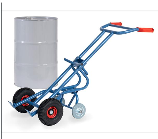
Ensemble mécano-soudé, revêtement époxy bleu RAL 5007. Diabale compatible pour fûts acier de 200 litres avec rebord. Roues gonflables, moyeu à roulement à rouleaux. 2 roues d'appui à bandage caoutchouc bleu gris Ø 160 x 40 mm. Permet de positionner les fûts remplis de façon sûre sur des palettes ou bacs de rétention d'une hauteur jusqu'à 360 mm. Longueur : 1600 mm ; Largeur : 680 mm.
