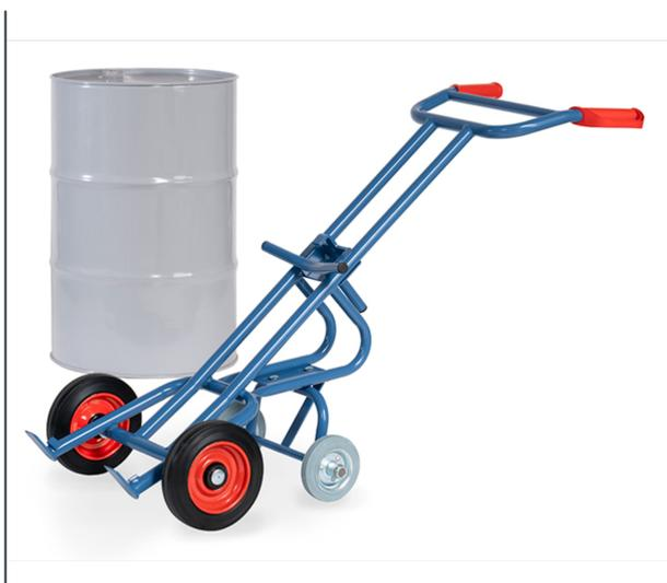
Ensemble mécano-soudé, revêtement époxy bleu RAL 5007. Diabie compatible pour fûts acier de 200 litres avec rebord. Roues à bandage caoutchouc, moyeu à roulement à rouleaux. 2 roues d'appui à bandage caoutchouc bleu gris Ø 160 x 40 mm. Permet de positionner les fûts remplis de façon sûre sur des palettes ou bacs de rétention d'une hauteur jusqu'à 360 mm. Longueur : 1600 mm ; Largeur : 680 mm.
