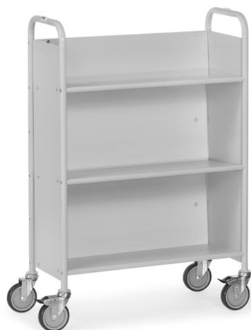
Ensemble mécano-soudé, revêtement époxy gris clair RAL 7035. 3 plateaux avec cloisons inclinés de 27 mm par rapport à l'angle droit. Longueur totale : 855 mm, largeur totale : 400 mm. 4 roues pivotantes à bandage TPE élastique non traçant, moyeu à palier lisse. 2 roues avec freins conformément à la Norme 1757-3. Charge maximum par étagère : 50 kg.
