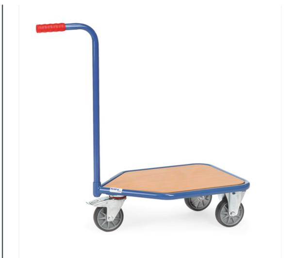
Chariot à col de cygne en tube d'acier, revêtement époxy bleu RAL 5007 avec plateau bois, poignée à boulonner, 1 roue pivotante avec frein et 2 roues fixes à bandage TPE 125 x 32 mm, moyeu à roulement à billes central.
